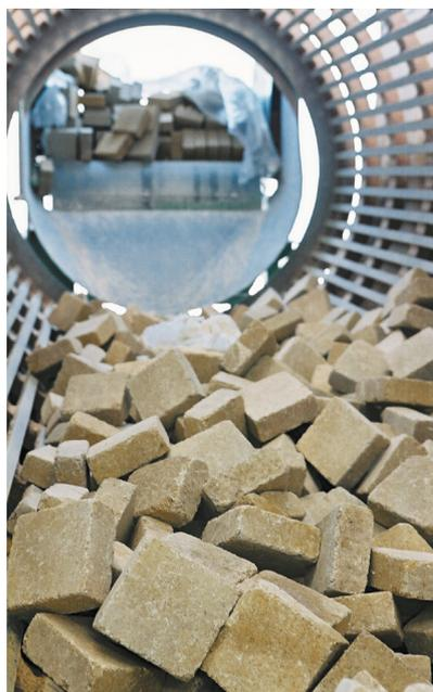
L'aspect vieilli très prisé des pavés béton Alkern est obtenu dans ce tambour.
